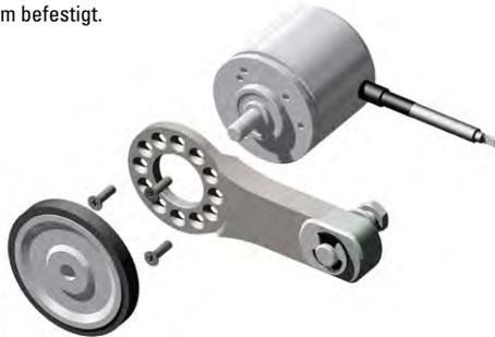
Die Befestigungspunkte sind so ausgelegt, dass eine beidseitige Montage am Federarm möglich ist.
